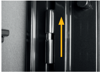
Abbildung 1. Die Tür kann nur herausgehoben werden, wenn sie vollständig aus ihrem Rahmen ausgetreten ist. Genau senkrecht nach oben heben, um Beschädigungen der Scharnierbolzen zu vermeiden
