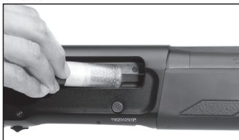
Mata in en patron genom utkastarluckan in i patronläget.
