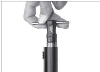
Zum Ein- und Ausbauen des Chokes den speziellen Choke-Schlüssel verwenden
