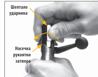
Поверните заднюю часть затвора по часовой стрелке до совпадения шептала ударника и насечки на рукоятке затвора.
